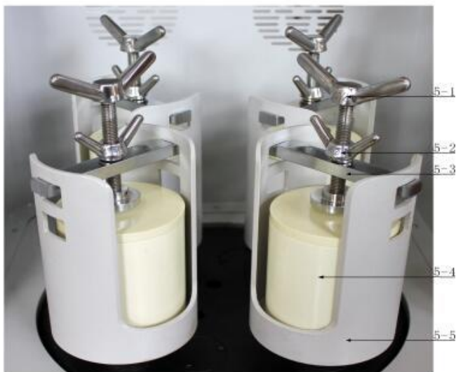
图5 立式行星球磨机磨罐座及顶紧装置实物图
