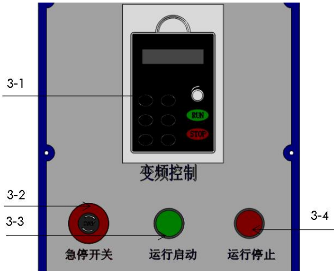
图 3 立式行星球磨机变频器控制面板示意图（由面板上的启动、停止按钮控制设备的启动、停止，变频器上的启动、停止键无效）
