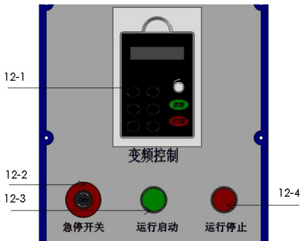
图 12 卧式行星球磨机变频器控制面板示意图（由面板上的启动、停止按钮控制设备的启动、停止，变频器上的启动、停止键无效）
