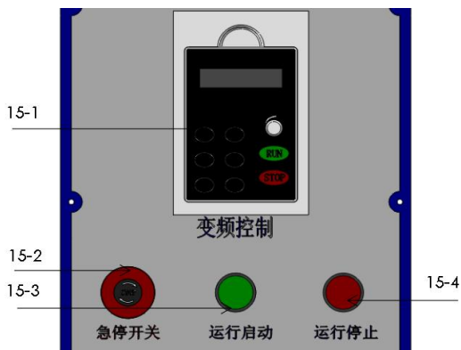
图 15 双行星球磨机变频器控制面板示意图（由面板上的启动、停止按钮控制设备的启动、停止，变频器上的启动、停止键无效）
