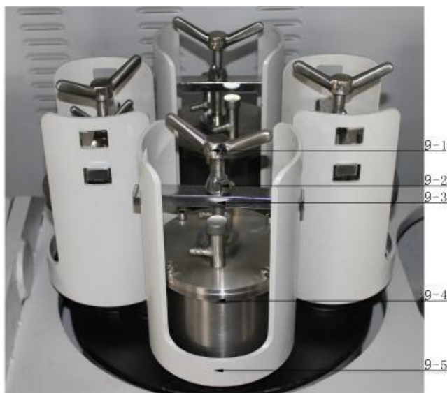
图9 全方位行星球磨机磨罐座及顶紧装置实物图
