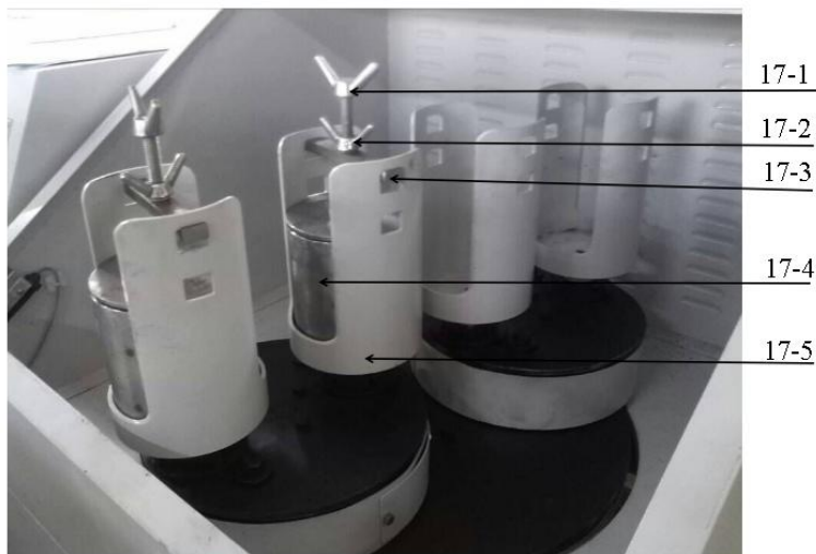
图 17 双行星球磨机磨罐座及顶紧装置实物图
