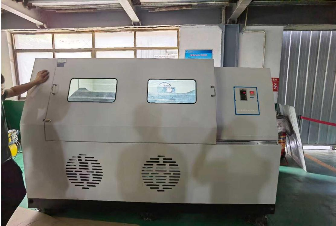
QM-QX60 全方位行星式球磨机是混合、细磨、小样制备、新产品研制和小批量生产高新技术材料的装置。该产品体积小、功能全、效率高、噪音低，是科研单位、高等院校、企业实验室获取研究试样（每次实验可同时获得四个样品）的理想设备。
